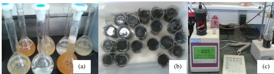
Figura 2: Montagem dos ensaios de hidrólise enzimática da espuma: a) preparado enzimático; b) frascos contendo espuma hidrolisada e b) titulador automático
