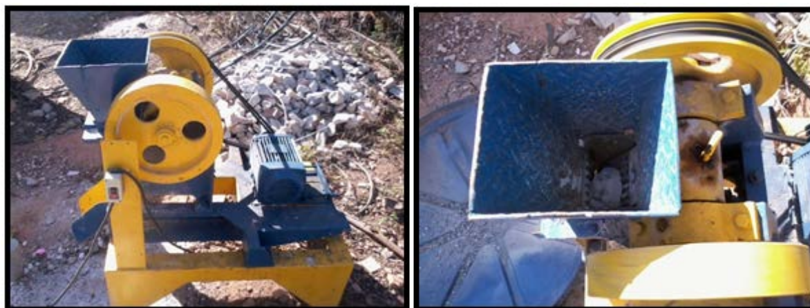
Figura 5a e 5b: Triturador de mandíbula. Fonte: Os autores (2014).
