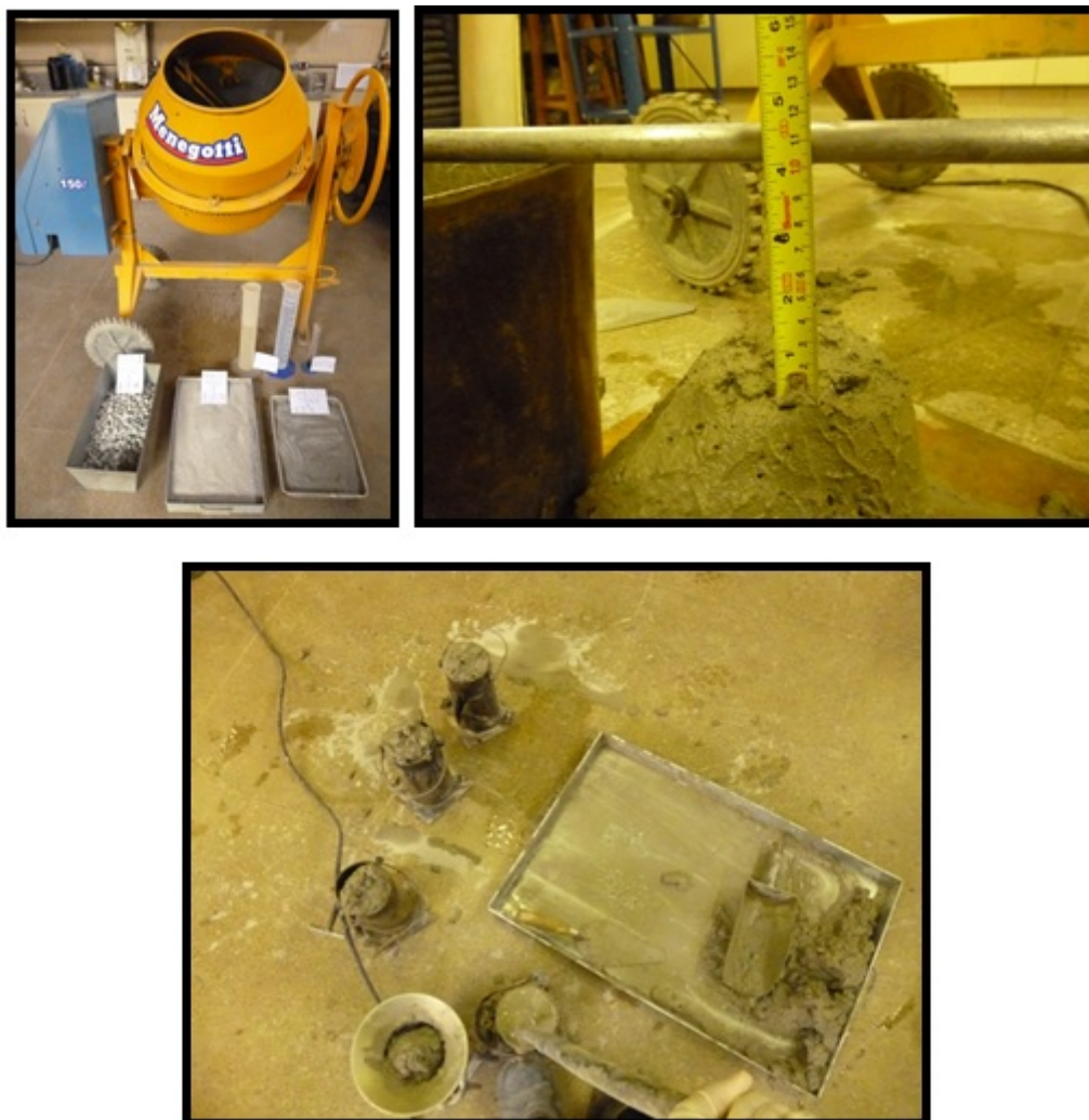
Figuras 22, 23 e 24: Material que compõe o traço, checagem do concreto e análise do abatimento do concreto. Fonte: Os autores (2014).
