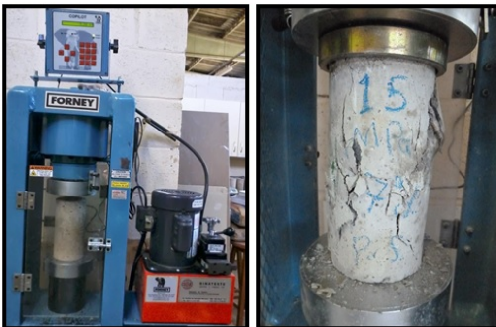
Figuras 25 e 26: Prensa para concreto Dina Teste (Forney) e rompimento do concreto. Fonte: Os autores (2014).
