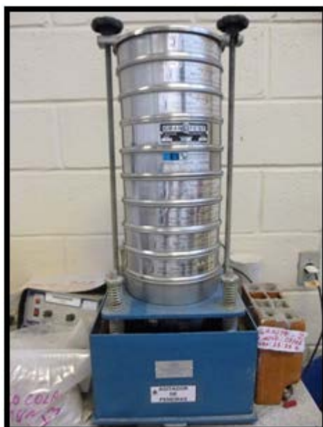
Figuras 9 e 10: Agitamento de peneiras mecânico e manual. Fonte: Os autores (2014).
