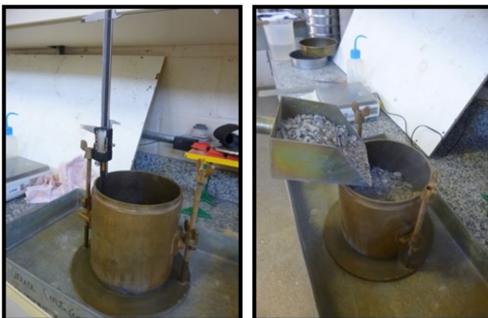
Figura 15 e 16: Determinando volume e enchimento do recipiente. Fonte: Os autores (2014).
