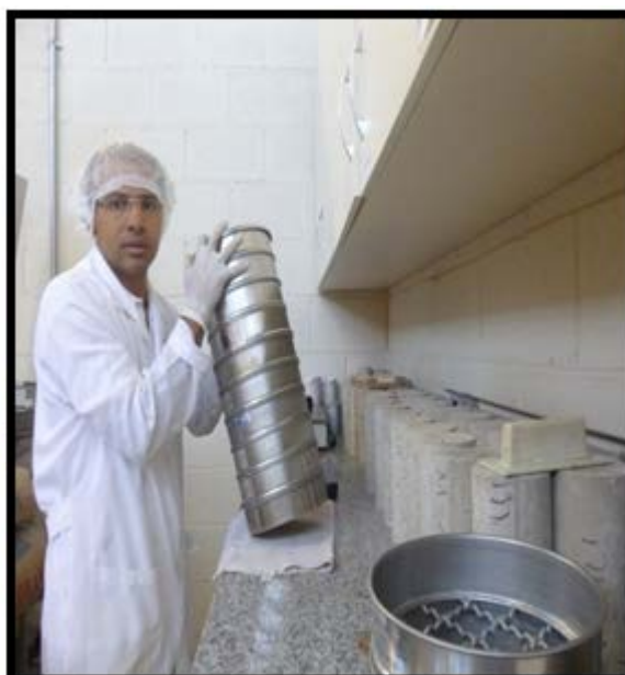
Figuras 9 e 10: Agitamento de peneiras mecânico e manual. Fonte: Os autores (2014).
