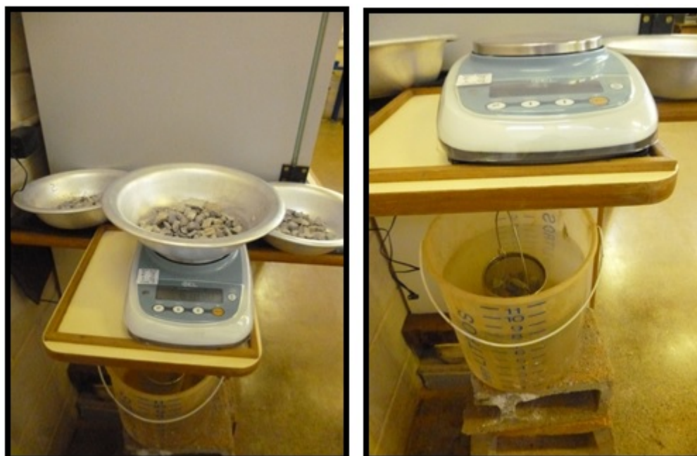
Figuras 13 e 14: Determinação da massa específica do agregado graúdo balança hidrostática. Fonte: Os autores (2014).
