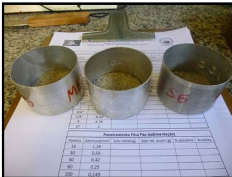
Figura 6: Agregado para determinação da umidade. Fonte: Os autores (2014).
