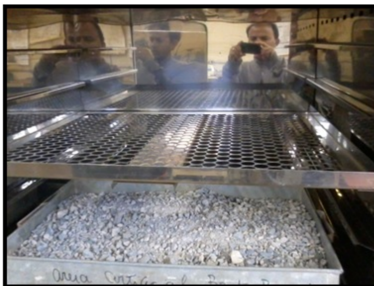
Figura 8: Secagem dos resíduos em estufa. Fonte: Os autores (2014).
