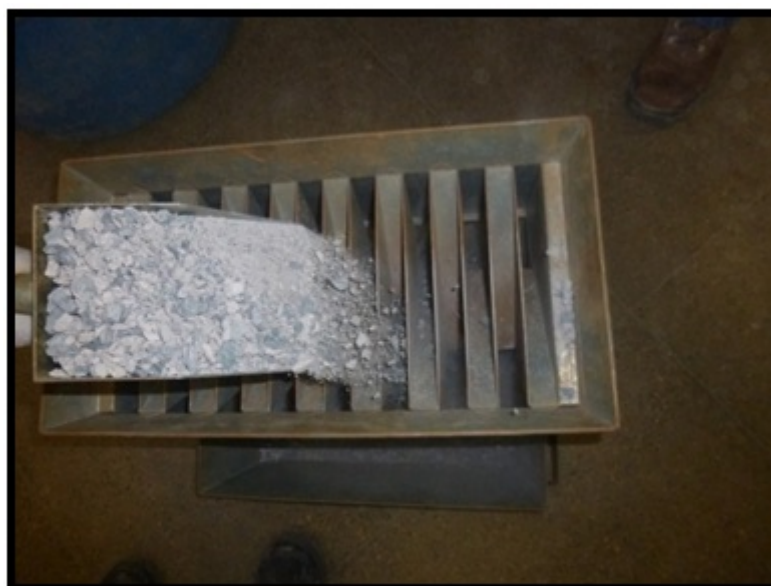
Figura 7: Quarteamento de agregados. Fonte: Os autores (2014).
