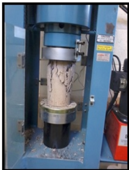
Figuras 1 e 2: Corpo de prova sendo rompido na prensa e corpo de prova já rompido. Fonte: Os autores (2014).
