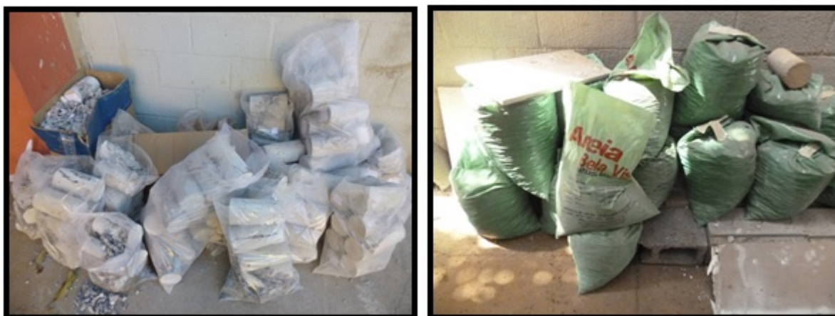
Figuras 3 e 4: Estocagem dos resíduos dos corpos de provas depois de rompidos e triturado. Fonte: Os autores (2014).
