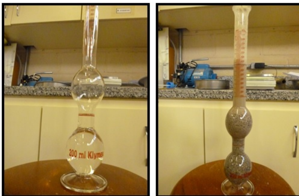
Figuras 11 e 12: Determinação de massa específica do agregado miúdo pelo frasco de Chapman.
