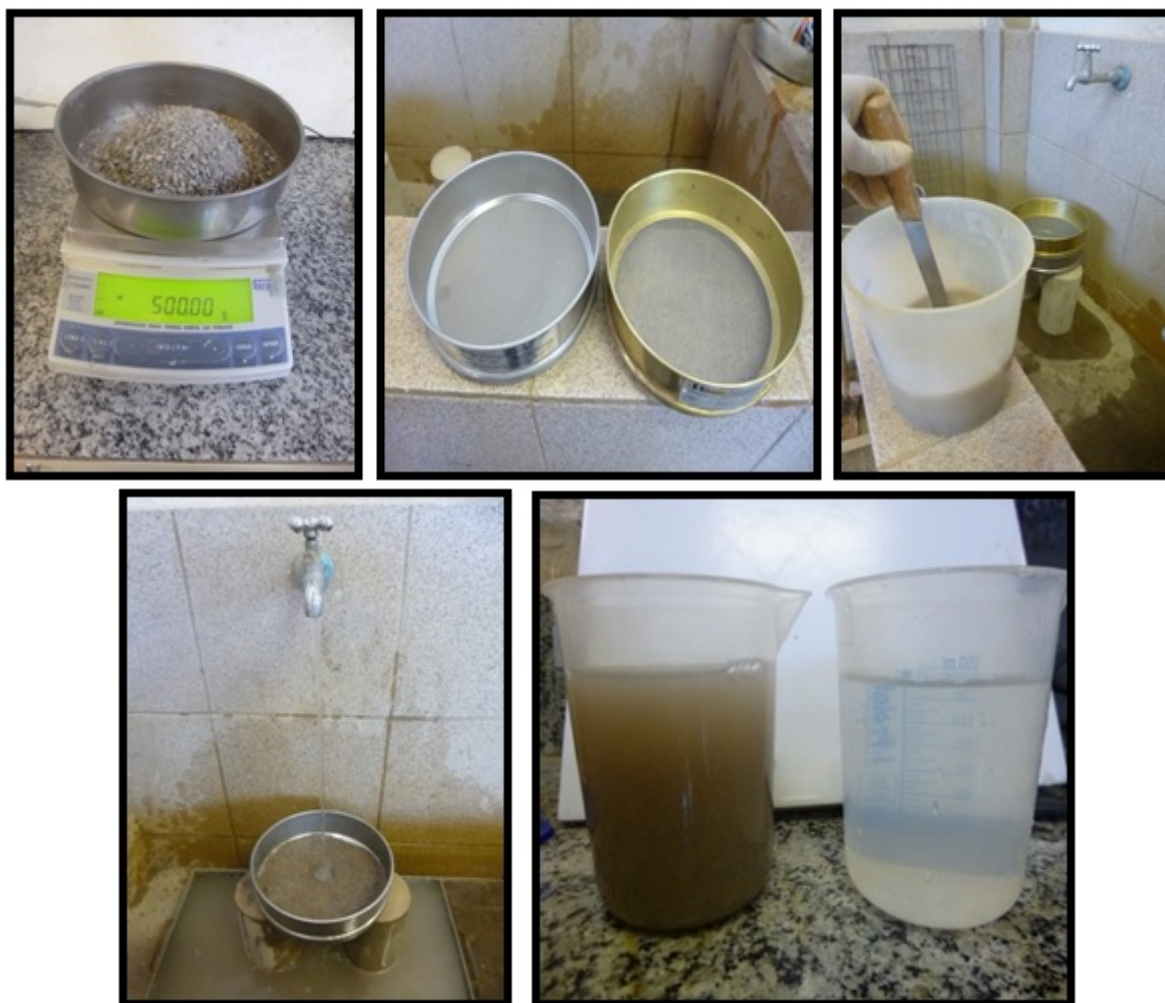
Figuras 17, 18, 19, 20 e 21: Pesagem do agregado, peneiras utilizadas, homogeneização, Lavagem do agregado e comparativo do teor de material pulverulento. Fonte: Os autores (2014).
