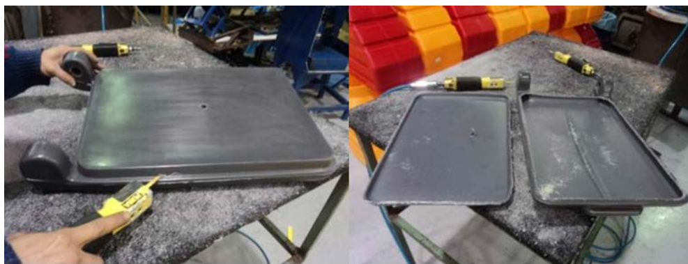
Figura 3: Tampa de Reservatório com apara sendo cortada.
