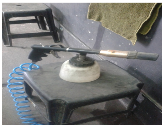
Fig. 14: Equipamento de injeção de ar para limpeza dos tapetes dos veículos.
