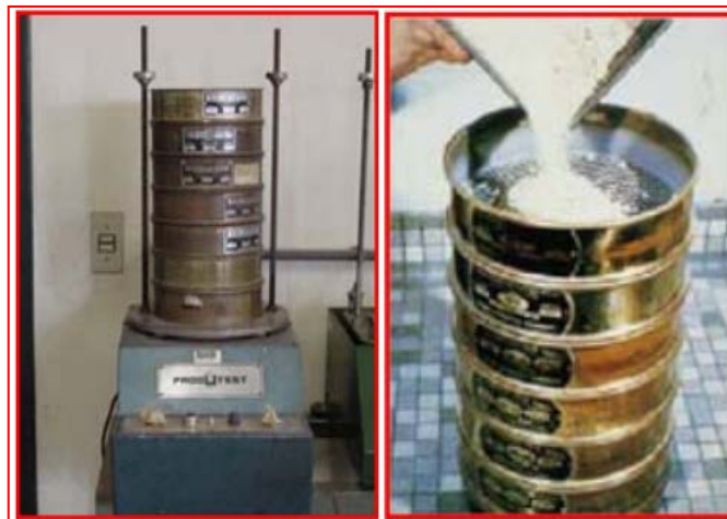
Figura 7 – Ensaio de peneiramento mecânico e sedimentação. 2014.
