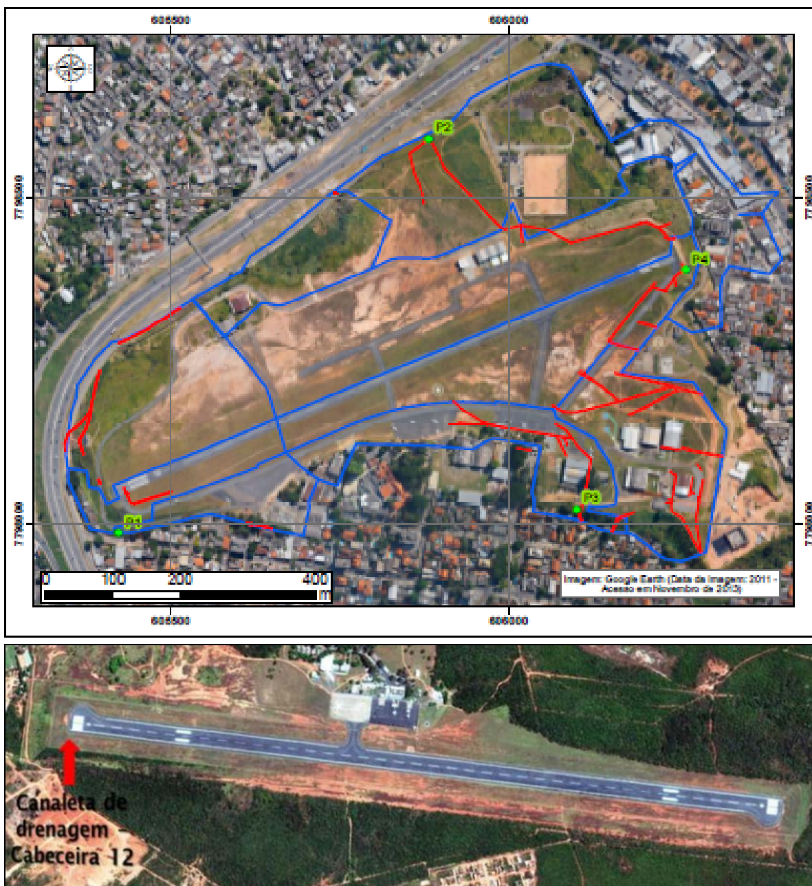
Figura 1: (a) vista aérea do Aeroporto Carlos Prates, com indicação dos pontos de coleta nas saídas dos canais de drenagem que receberam contribuições dos pátios e da pista; (b) vista aérea do Aeroporto de Montes Claros, com indicação do ponto de monitoramento no final do sistema de drenagem de pátio e pista.
