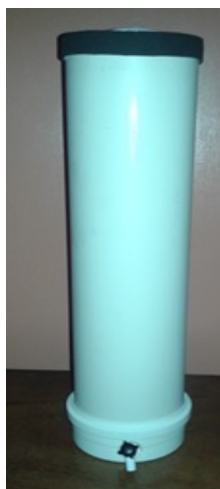
Figura 1: Filtro de carvão ativado oriundo do caroço de açaí
