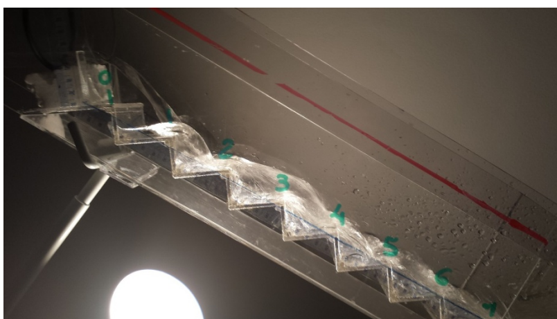
Figura 8 – Detalhe do Escoamento ( Nappe Flow ) com Tubulação de Chegada com Declividade 20% e y/D=0,10
