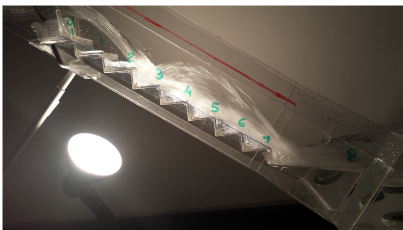
Figura 6 - Comportamento com Tubulação de Chegada com Declividade de 20% e y/D=0,30 ( Skimming Flow )
