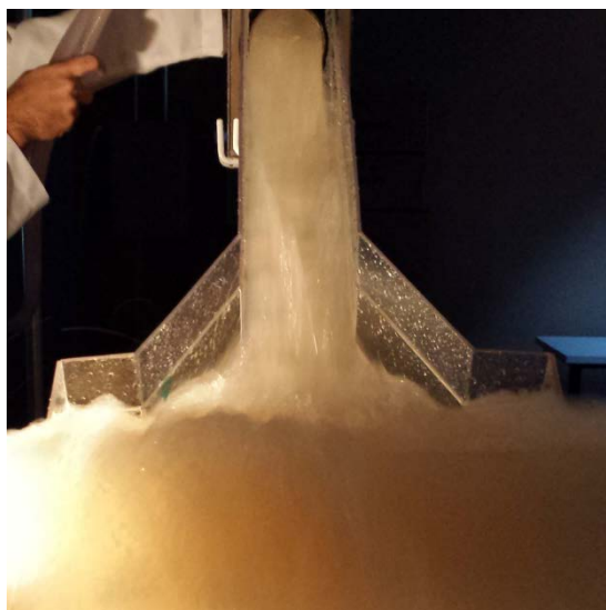
Figura 10 – Vista Frontal do Escoamento ( Skimming Flow ) com Tubulação de Chegada com declividade 15% e Seção Plena (Notar a Grande Turbulência e Energia na Bacia de Dissipação)
