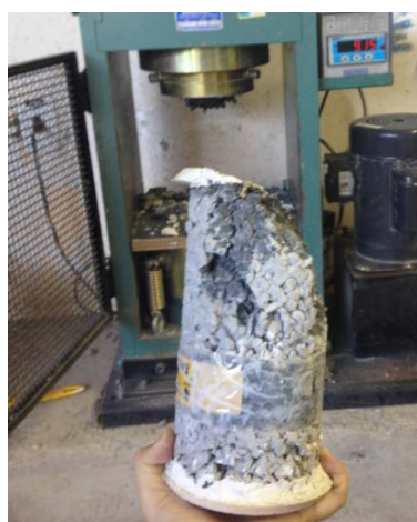
Figura 3: Corpo de prova cilíndrico após rompimento a compressão.
