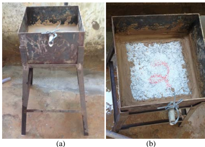
Figura 1: (a) 'Grelha' utilizada no experimento. (b) Amostra pronta para o ensaio após vedação com argila.
