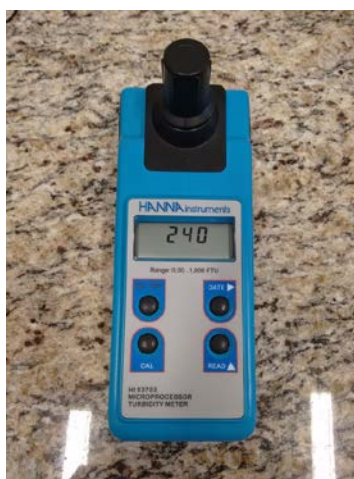
Figura 2: Instrumento utilizado para quantificar turbidez.
