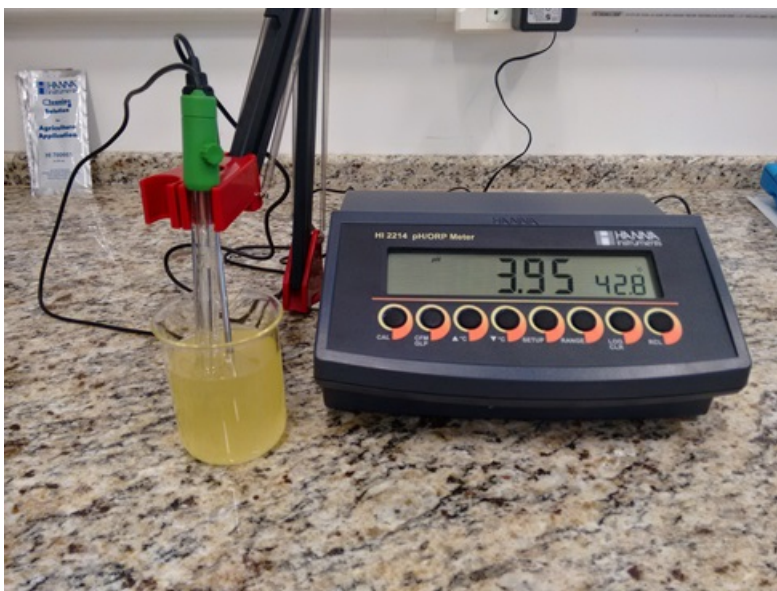
Figura 3: Instrumento utilizado para quantificar pH.
