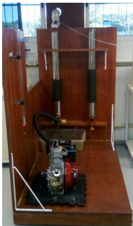
Figura 1: Motor estacionário acoplado à coluna de absorção
