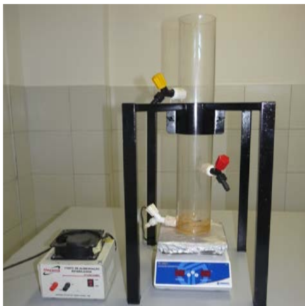
Figura 3 - Reator eletrolítico em escala de laboratório e diagrama experimental do reator.
