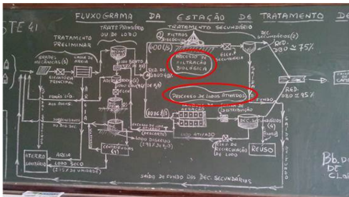
Figura 4: Desenho esquemático operacional da ETE Penha registrado no quadro da sala de cursos.
