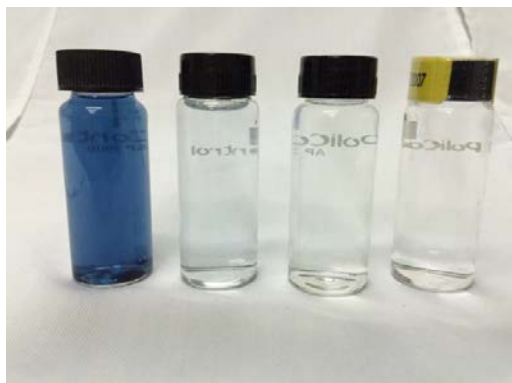
Figura 6: Comparação do Efluente Bruto X tratado com Sulfato de Alumínio X tratado com descolorante X controle (água destilada) - Fonte: Arquivo Pessoal
