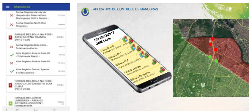
Figura 1 – Identificação das manobras no aplicativo no smartphone x áreas de abastecimento
