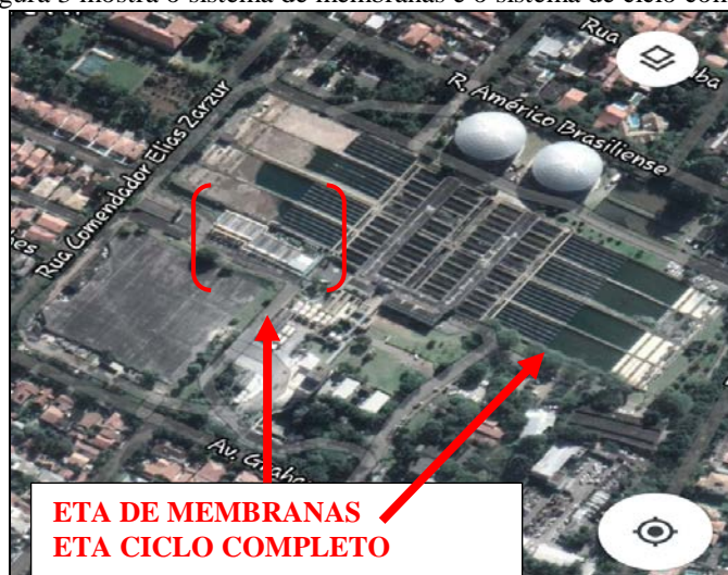
Figura 3-Vista aérea da ETA Engenheiro Rodolfo José Costa e Silva. Evidência da diferença de área ocupada pelo sistema de membranas e o sistema de ciclo completo.
