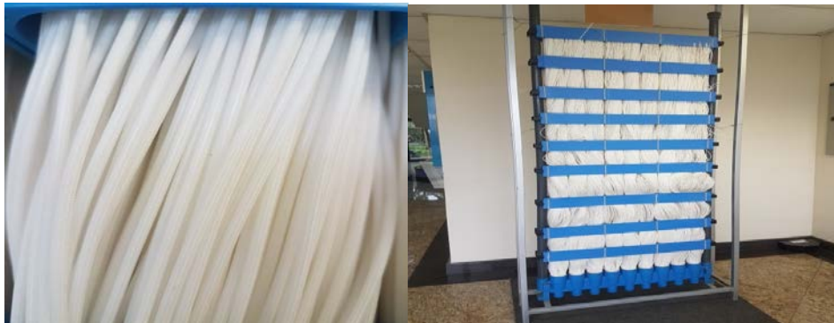
Fotografia 1-Fileira de membranas para o módulo
