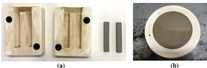
Figura 1: Fotografia do molde de gesso utilizado para confecção dos CPs (a) e do molde para testes de produção de peças (velocidade de colagem ou deposição) durante a execução de um dos testes (b).
