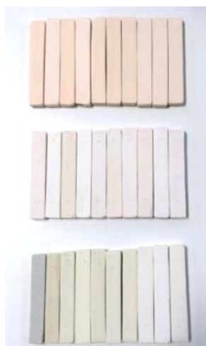
Figura 2: Corpos de prova sinterizados a 1000°C (em cima), 1150°C (no meio) e 1200°C (em baixo)
