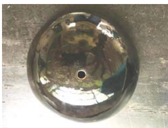
Figura 3: Peça produzida com lodo e esmaltada (esmalte negro); sinterização a 1200°C.
