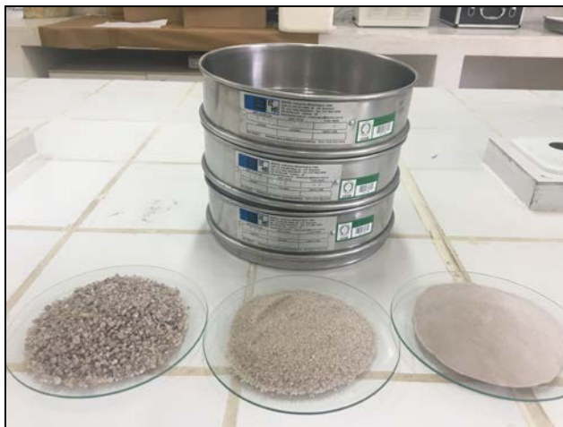
Figura 1: Peneira para análise granulométrica e amostras de areias usadas no filtro.
