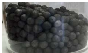
Figura 1 – Material suporte (sílica) impregnado com AgNPs.
