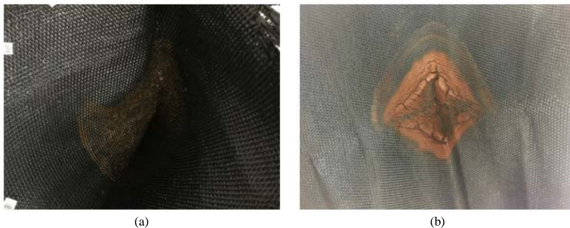
Figura 4 - Aspecto do retido no Teste do Cone realizado com a adição de floculante a 10 \text{ mg L}^{-1} após o tempo de: a) 0 a 5 min; b) 45 a 60 min (torta formada).
