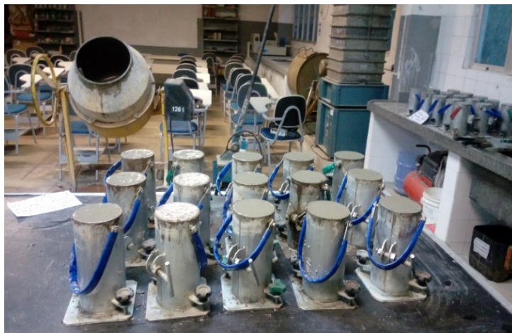
Figura 1: Corpos de prova de concreto produzido com efluente.
