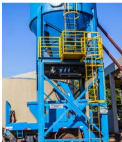
Figura 3: Armazenamento de LETE desaguado em Silos.
