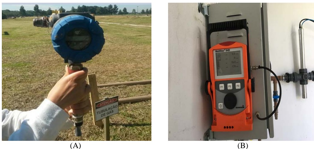
Figura 5. Foto dos analisadores de biogás: (A) vista frontal do medidor de vazão de biogás por dispersão térmica; (B) vista lateral do analisador de qualidade do biogás (Multitec 545)
