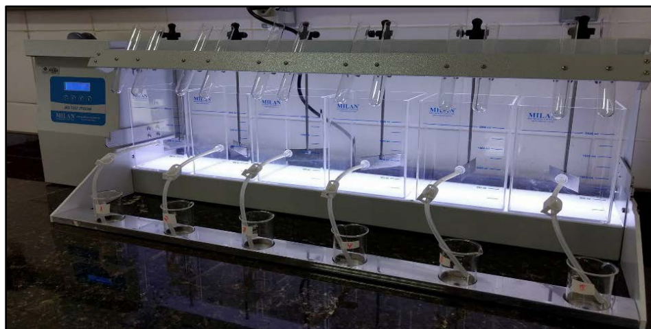
Figura 2: Equipamento Jar-test Fonte: Autor (2017).
