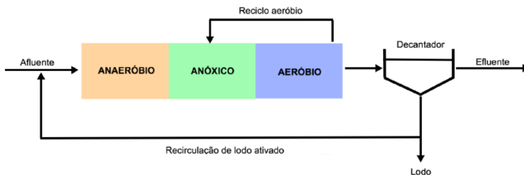
Figura 1 - Configuração de processo A 2 O (modificado de Metcalf e Eddy, 2014).
