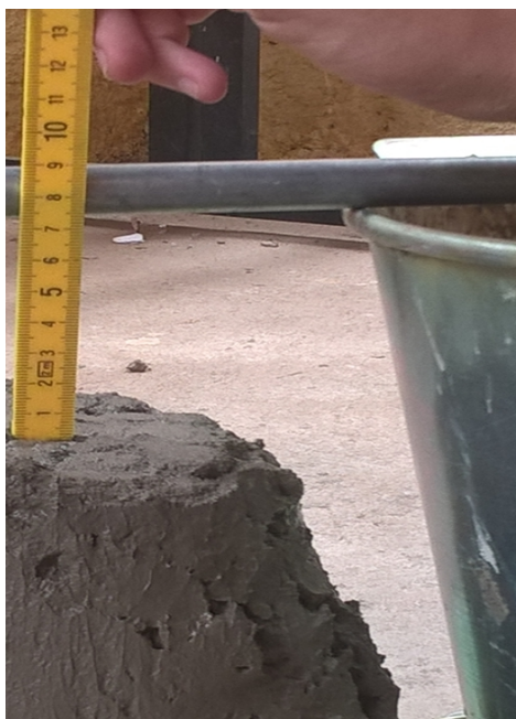
Figura 5 - Teste de abatimento de tronco de cone em concreto produzido com água potável.
