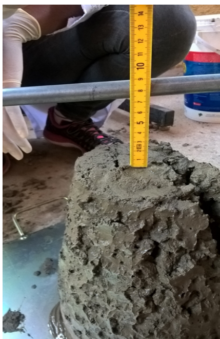
Figura 6 - Teste de abatimento de tronco de cone em concreto produzido com efluente tratado.
