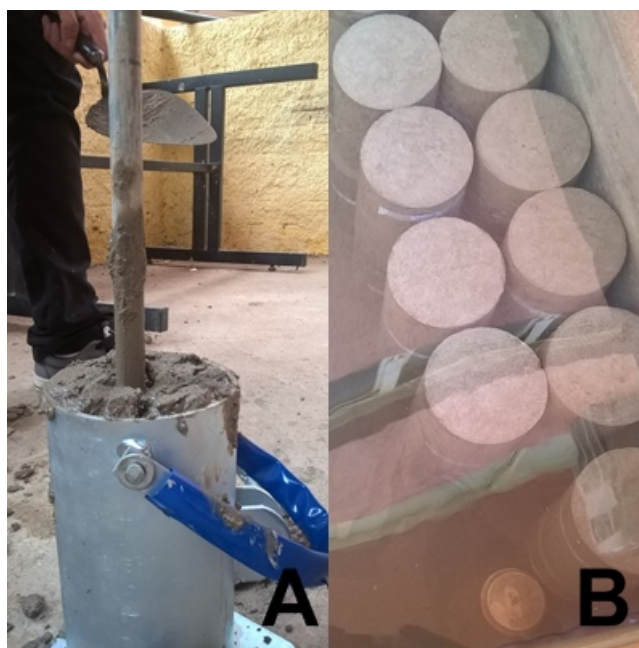
Figura 3 – Moldagem (A) e cura (B) de corpos de prova cilíndricos.
