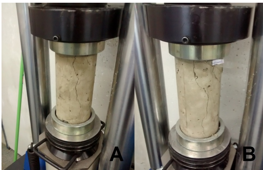
Figura 4 – Ensaio da resistência à compressão simples de concreto feito com água potável (A) e outro feito com efluente tratado (B).
