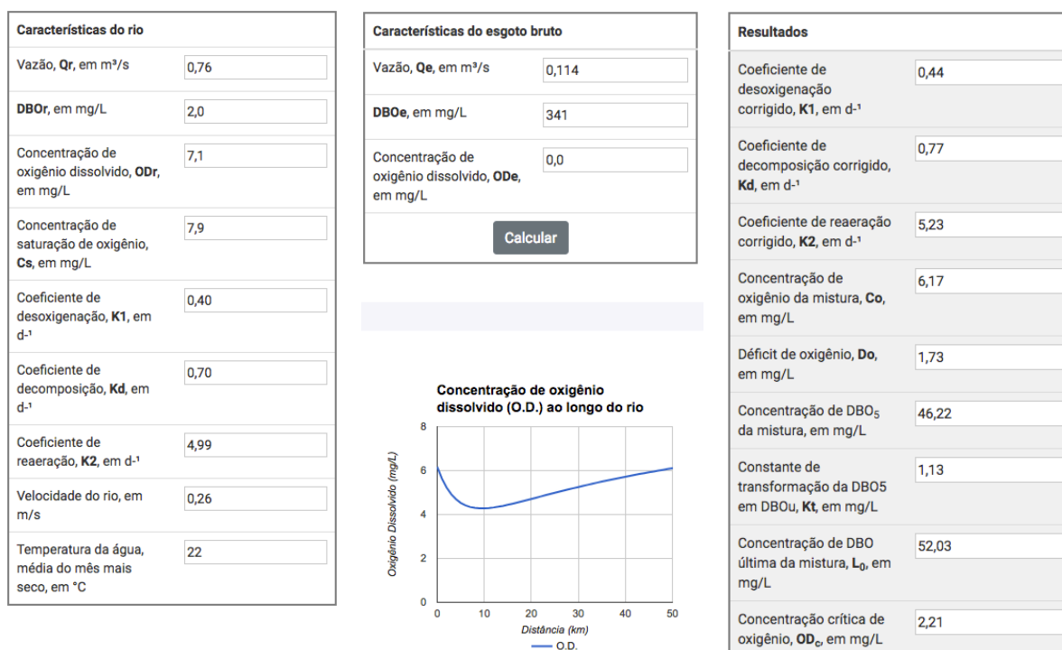
Figura 6: Resultados obtidos na página da aplicação, na análise da autodepuração de um corpo hídrico com lançamento pontual único.
