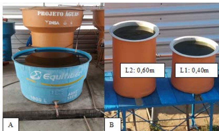
Figura 1 – Reator UASB em operação na estação experimental (A); Sistema de Lagoas de Polimento (B).
