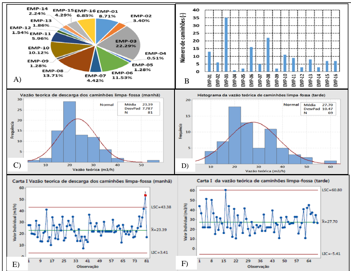
Figura 2: A) Gráfico de torta; B) Gráfico de barras; C), D), E) e F) Gráficos de histogramas e de controle de caminhões limpa-fossa para os períodos de manhã e da tarde.
