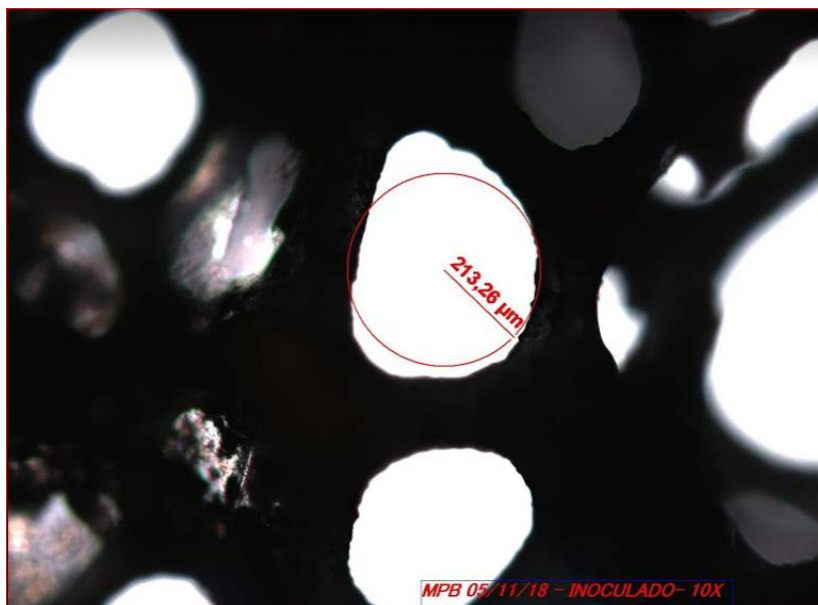
Figura 1 - Avaliação microscopia da mídia de poliuretano enriquecida 1 – após 06 meses de operação na ETE Gêneses
