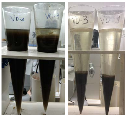
Figura 2: Medição dos sólidos sedimentáveis através do cone Imhof, ocorrida na ETE estudada. À esquerda temos um registro de julho/2018 e a direita um registro de março de 2019.
