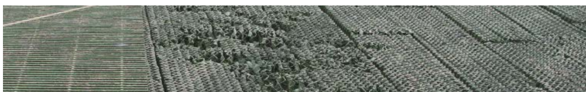
Figura 3: Meio suporte plástico estruturado em PVC, com a superfície danificada ao longo do tempo
