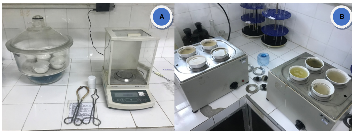
Figura 3: Pesagem das cápsulas (A); Amostras em Banho Maria (B) (Fonte: Autor, 2018).
