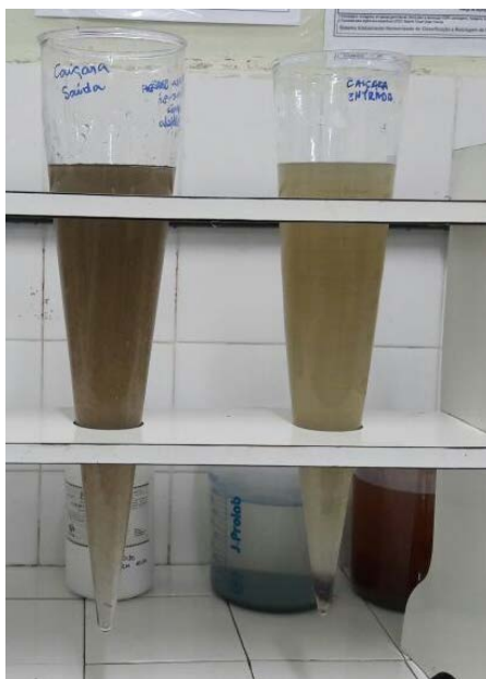
Figura 4: Cone de Sedimentação Imhoff (Fonte: Autor, 2018).
