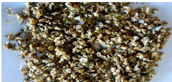
Figura 4 - Material bioadsorvente após ativação em ácido clorídrico 0,10 molar, e posterior secagem em estufa com circulação de ar a 80°C.
