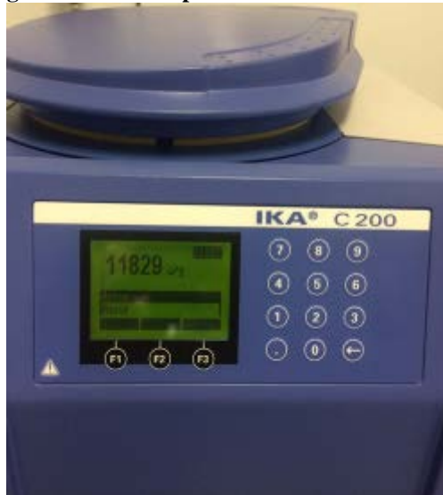
Figura 9 - Teste de poder calorífico no lodo seco
