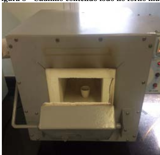
Figura 8 - Cadinho contendo lodo no forno mufla
