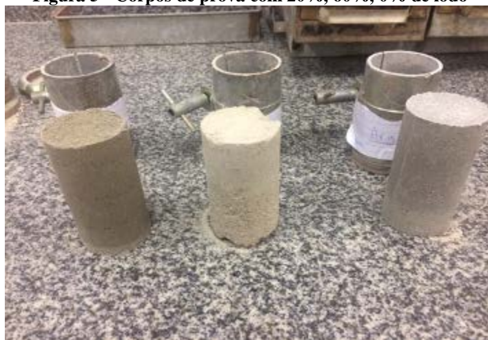
Figura 5 - Corpos de prova com 20%, 60%, 0% de lodo
