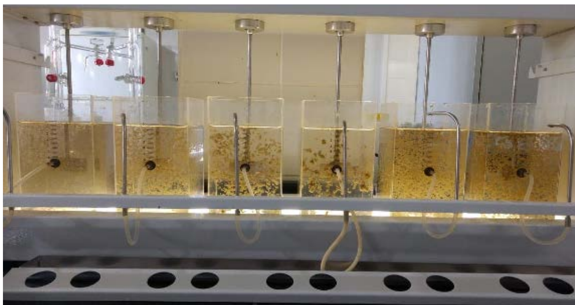
Figura 01 – Ensaio de jarros variando a dosagem de cloreto férrico – \text{FeCl}_3
