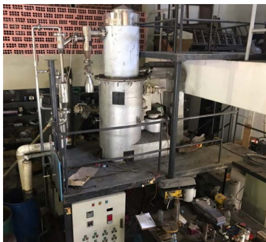
Figura 1: Foto do gaseificador de leito fixo.
