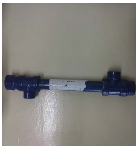
Figura 2: Módulo de microfiltração utilizado nos testes.
