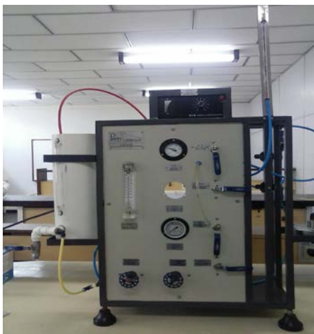
Figura 1: Equipamento de Microfiltração, Ultrafiltração e Nanofiltração em escala bancada.
