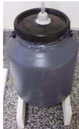
Figura 4. Protótipo simplificado do biodigestor em batelada.
