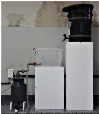
Figura 2. Protótipo do biodigestor em fluxo contínuo.
