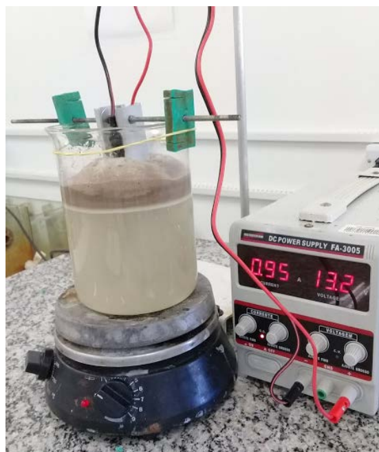
Figura 2. Sistema de eletrocoagulação com reator batelada de bancada
