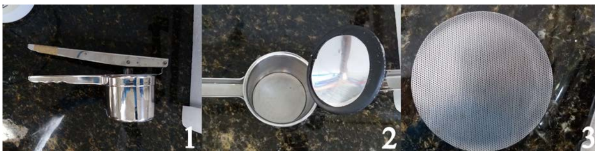
Figura 2 – Dispositivo Simulador de Deságue vista lateral (1), DSD aberto vista superior (2), tela metálica a ser posicionada ao fundo do DSD (3) conforme mostrado na imagem 2.
