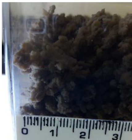
Figura 1 – Medição do floco formado no ensaio de floculação de lodo de esgoto, com polímero catiônico.
