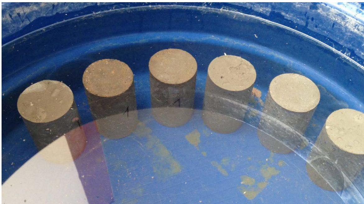
Figura 07: Realização da cura úmida dos corpos de prova. Fonte: Autores (2018).
