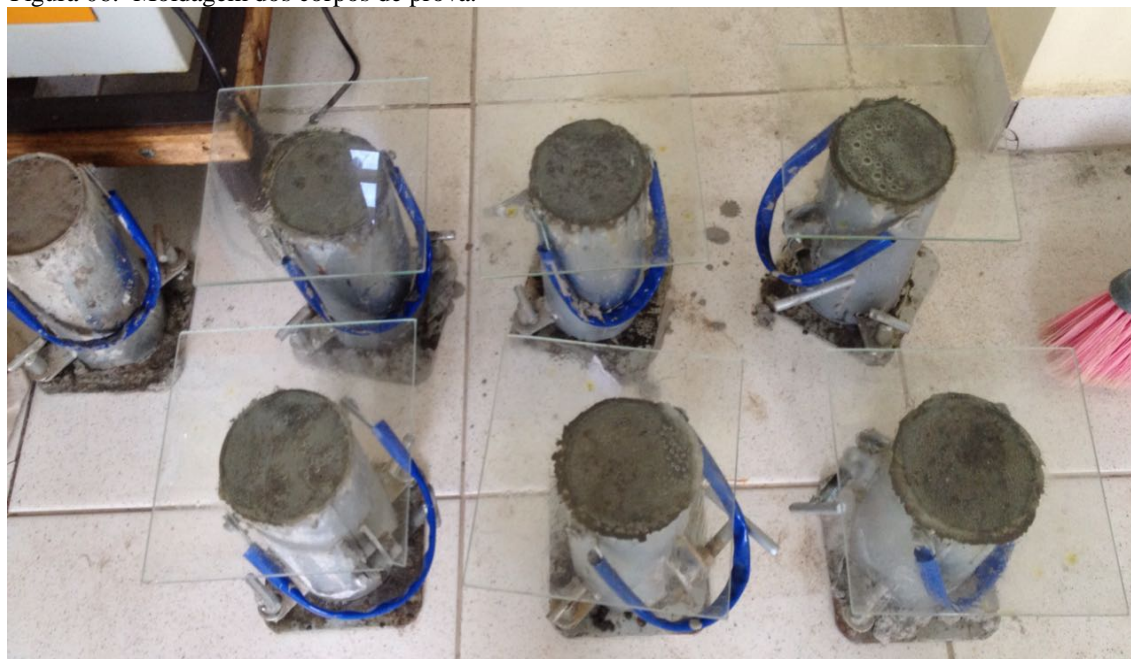
Figura 06: Moldagem dos corpos de prova Fonte: Autores (2018).
