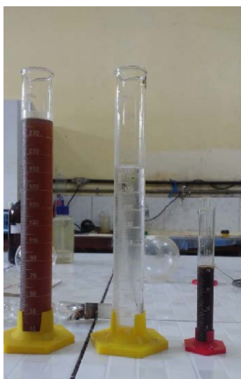
Figura 3: Lixiviado bruto, lixiviado tratado por destilação e borra residual.
