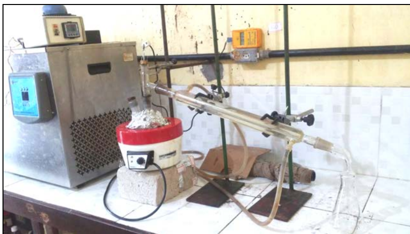
Figura 2: Equipamentos e vidrarias utilizadas para a destilação do lixiviado.
