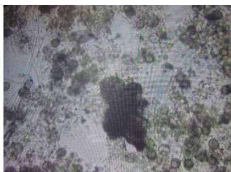
Figura 3 – Aspectos identificados dos flocos do lodo ativado (Floco Ideal).
