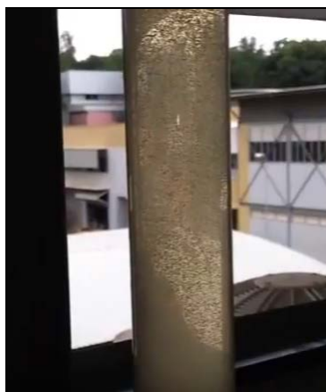
Figura 2: Cristais de estruvita formados na coluna de leito fluidizado.
