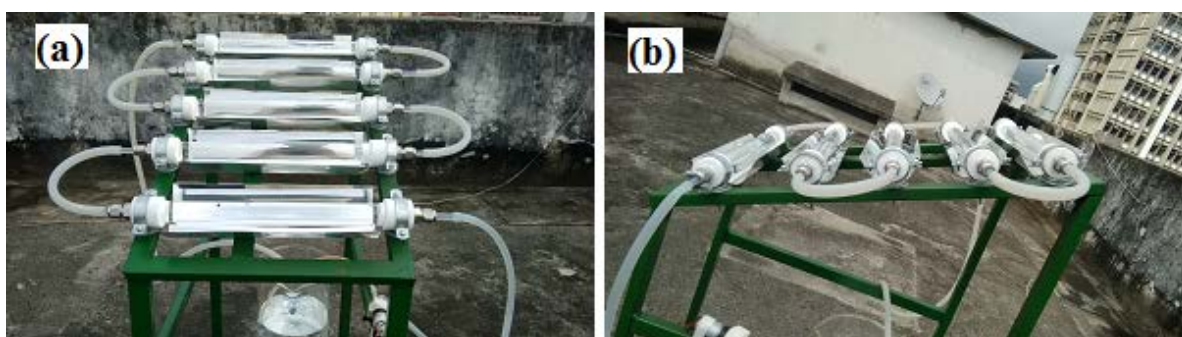
Figura 3: Vista frontal (a) e lateral (b) do reator tipo CPC em escala piloto instalado na UERJ.
