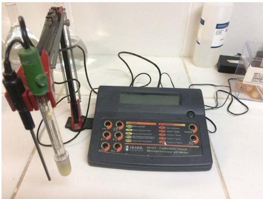
Figura 4 - pHmetro HI 221 Fonte: Próprio Autor, 2019.
