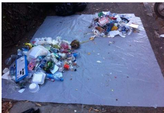
Figura 2: Técnica de Quarteamento dos Resíduos Sólidos (ABNT 10.007/04).
