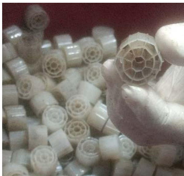
Figura 2- Biomídias utilizada no filtro biológico Fonte: Próprio autor
