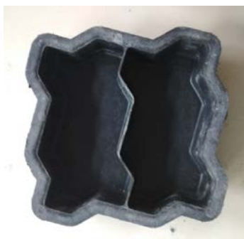
Figura 2 - Molde utilizado na moldagem dos Pavers
