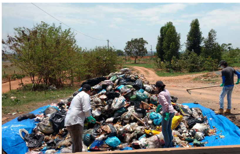
Figura 2 - Rompimento das embalagens dos resíduos e homogeneização.
